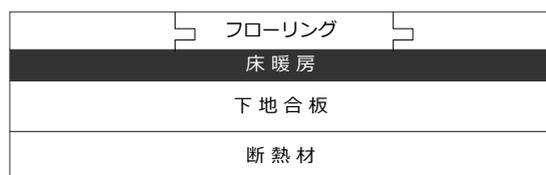
低温電気式フィルムタイプ施工方法
